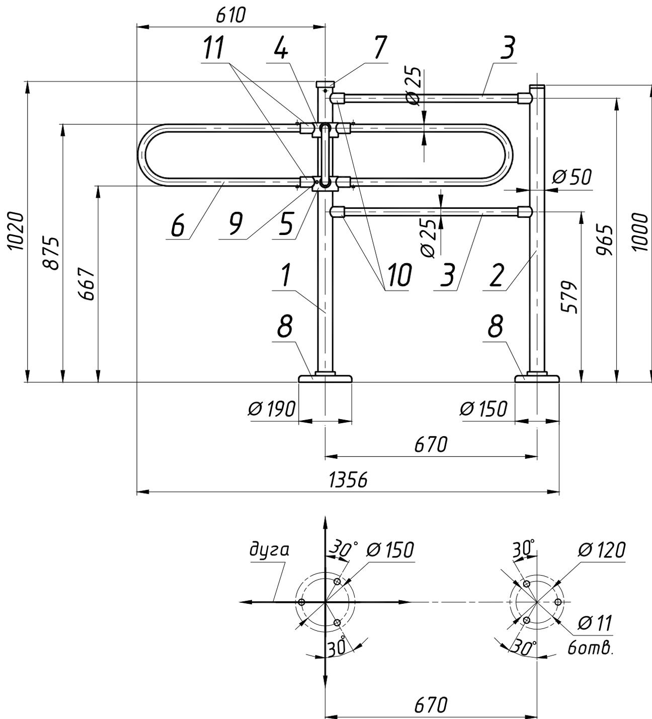
**Габаритные и установочные размеры роторных турникетов серии «Ростов-Дон Р31Мпр, Р31Млв, Р32М» (в турникетах Р32М замок 9 расположен на верхнем кольце 5)**
